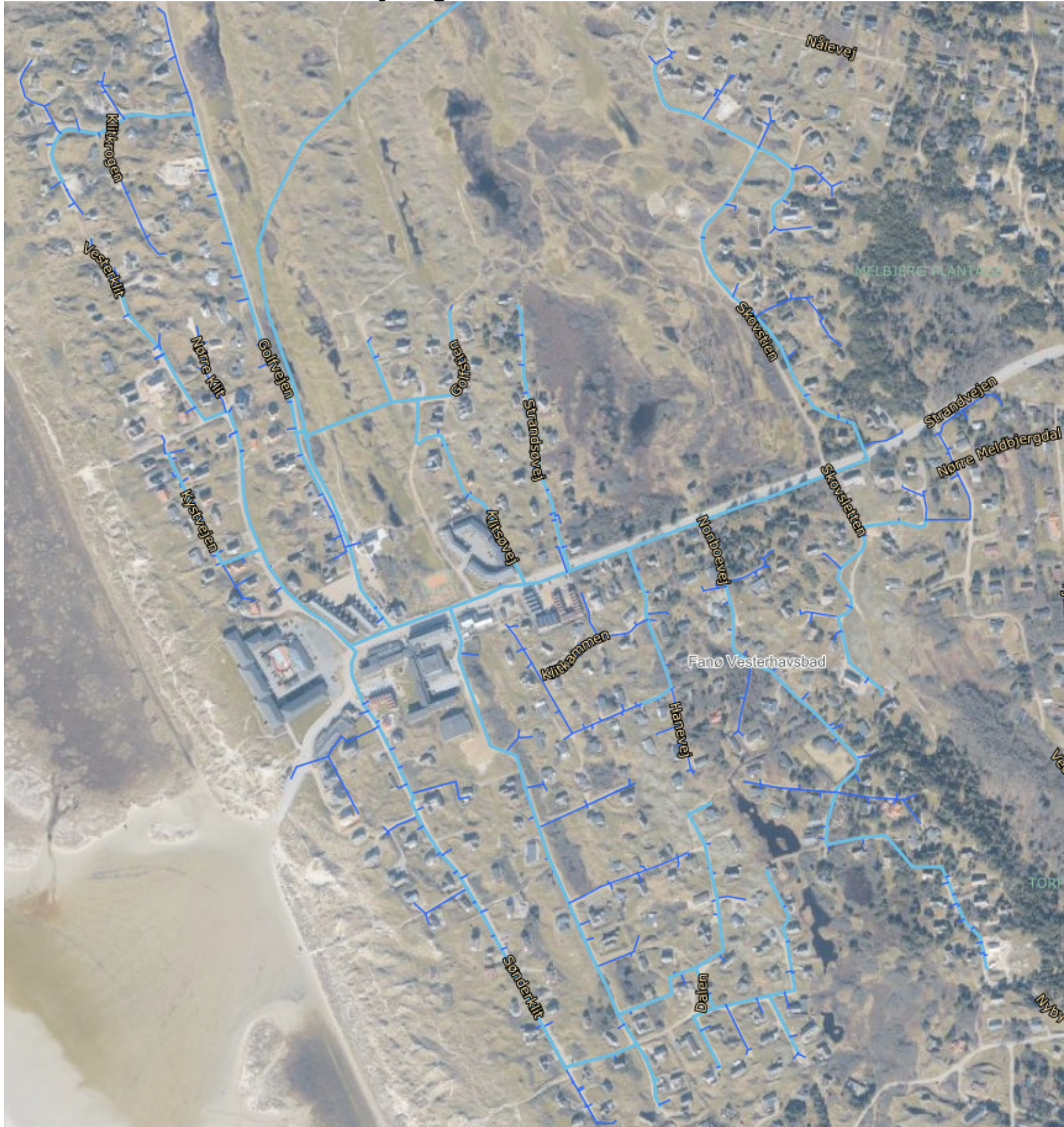
Fanø Vesterhavsbad vandforsynings ledningsnet (11-04-2023)
